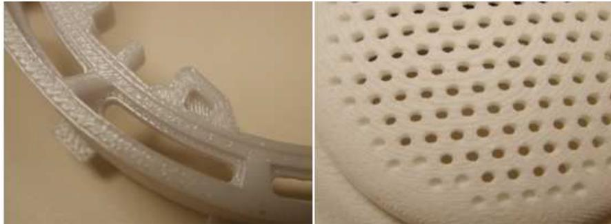
**Figura 34. Efecto escalonado en la superficie de la pieza.**
