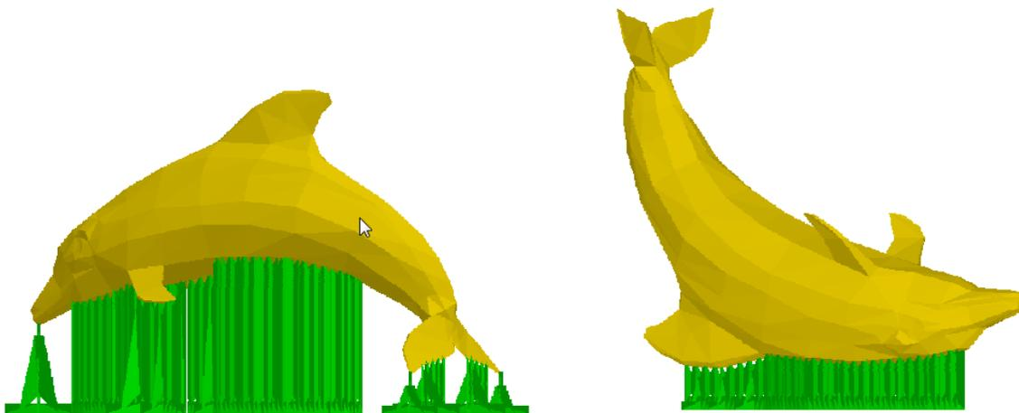
**Figura 33. Izquierda, esta orientación del modelo obliga a colocar más soportes que en la orientación de la derecha.**
