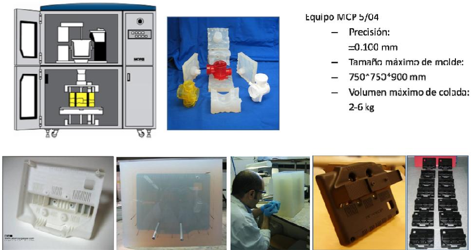
**Figura 22. Características y ejemplos de colada en vacío**
