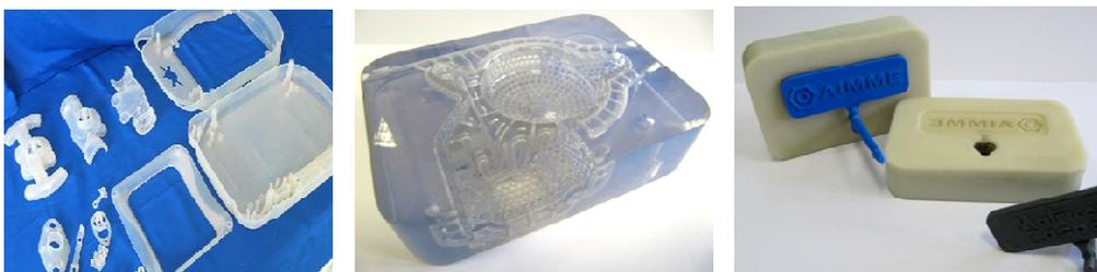
**Figura 8. Estereolitografía (materiales y características).**
