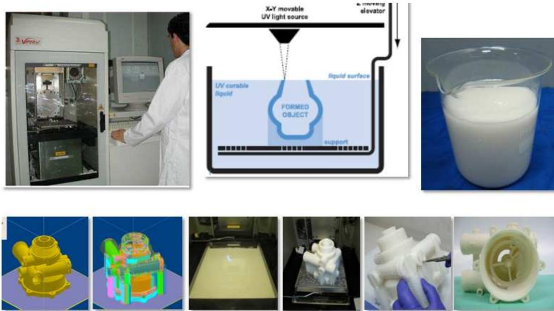
**Figura 7. Estereolitografía (máquina, proceso, material y piezas ejemplo).**
