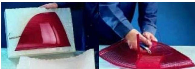
**Figura 25. Extracción de la pieza del molde**
